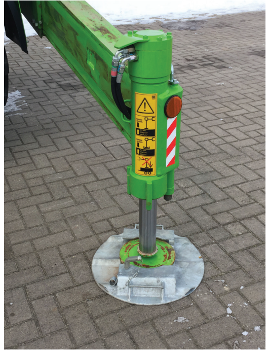
▣ Abb. 6.1 Richtiges Abstützen ist enorm wichtig
