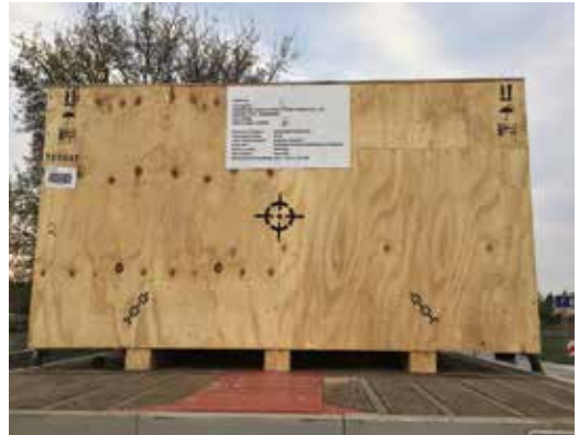
■ Abb. 3.2 Kennzeichnung des Lastschwerpunkts
